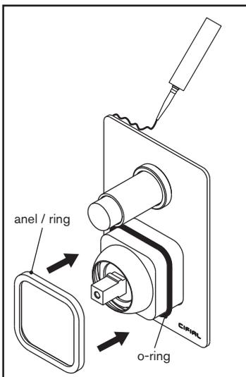
**Instalação do espelho:** Aplicar silicone entre a superfície posterior do espelho e a parede.
