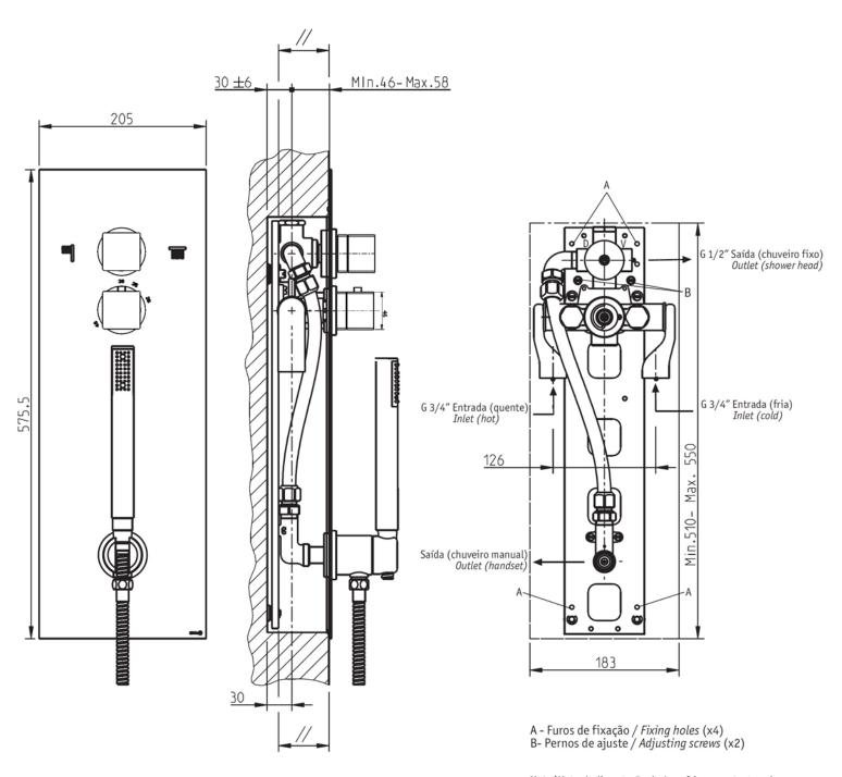
**Nota/Note:** A alimentação de água fria e quente, tem de ser localizada na metade inferior da caixa de alojamento do conjunto. The cold and hot water inlet, must be located on inferior middle of the housing set box.
